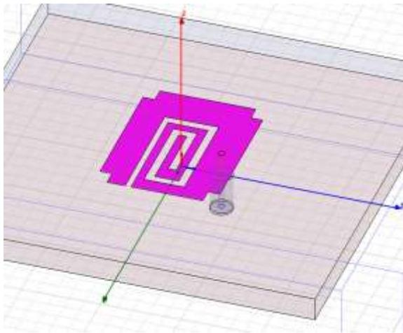
**Figure 1. Edge slot spiral antenna**
